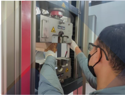
Gambar 4.3 Proses Pengujian Tarik
