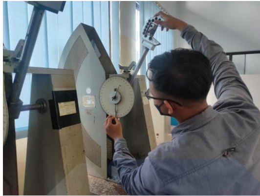
Gambar 4.5 Proses Pengujian Impak (alat terkalibrasi dengan baik)
