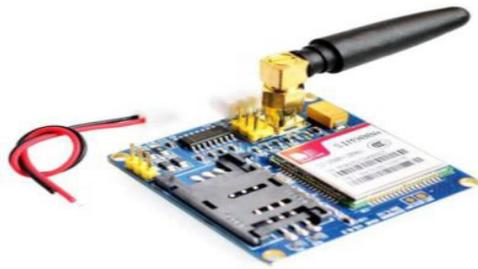
Gambar 4.5 Bentuk Fisik Modul GSM SIM900A
