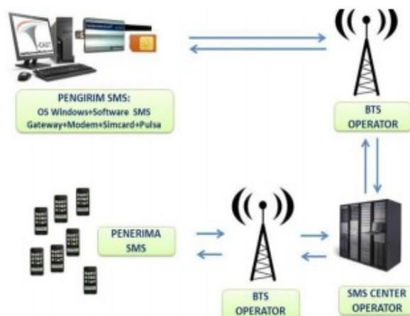
Gambar 2.3 Mekanisme kerja SMS Gateway [6]
