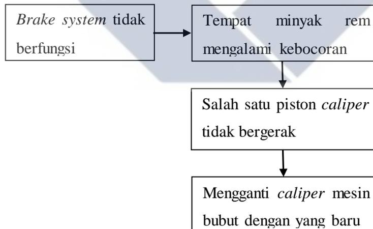
Gambar 4.2 Analisa *mechanical* pada *brake system*
