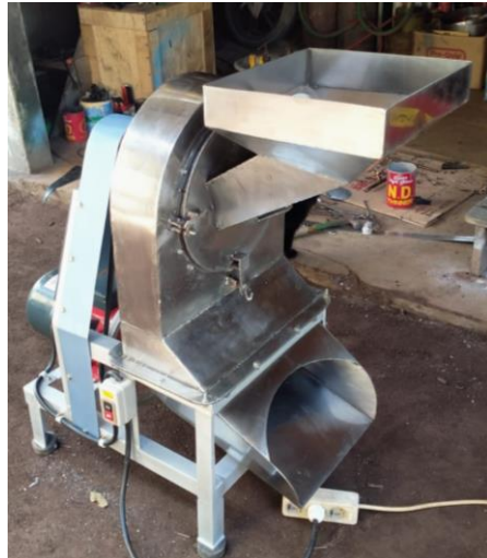
Gambar 4. 15 Mesin Penepung Umbi Keladi Beneng
