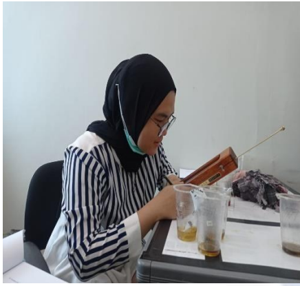
Pengecekan viskositas pelumas menggunakan visgaga
