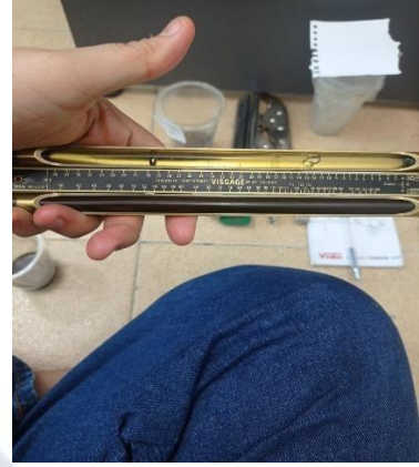
Pengecekan viskositas pelumas menggunakan visgaga
