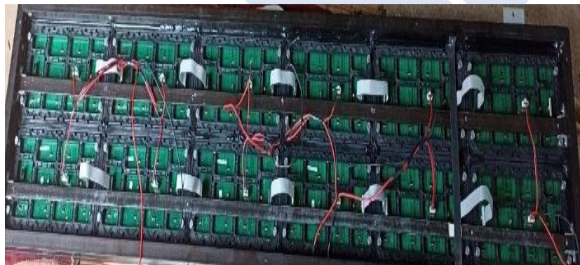
Gambar 4. 5 Perekatan Dot matrix Display P10 Dengan Frame
