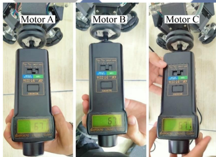
Gambar 4.1 Pengujian Kecepatan Masing-Masing Motor Stepper dengan Target Kecepatan 70 RPM
