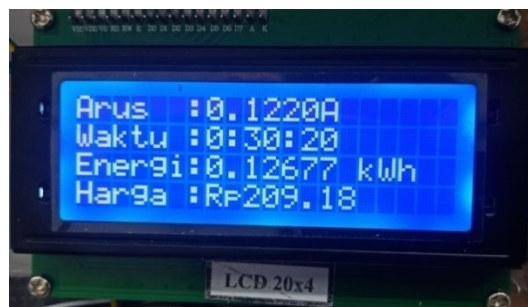
Gambar 4.18 Tampilan LCD pengisian baterai dengan tambahan beban 75Ω
