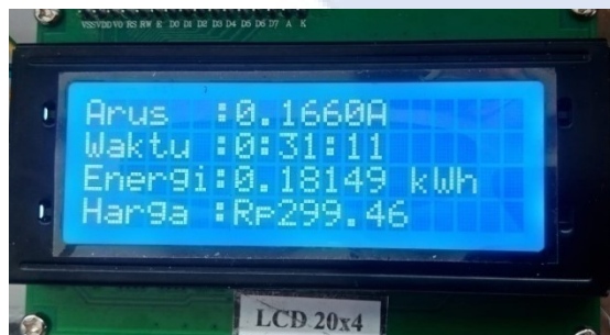
Gambar 4.17 Tampilan LCD pengisian baterai dengan tambahan beban 50Ω
