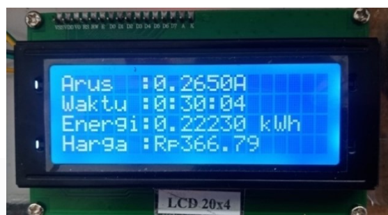
Gambar 4.16 Tampilan LCD pengisian baterai dengan tambahan beban 25 \Omega
