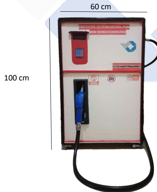
Gambar 4.1 Prototipe Sistem Kontrol Pom Mini Berbasis Arduino
