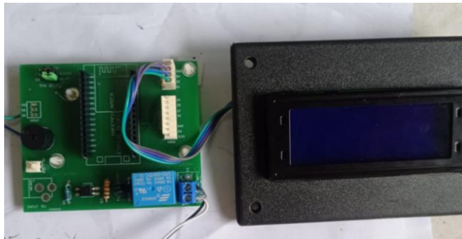
Gambar 4.6 Tampilan posisi LCD 20x4
