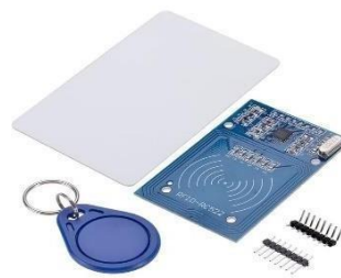
Gambar 2.1 Module RFID RC522 + card RFID
