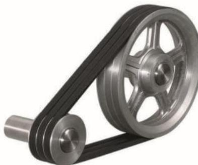
Gambar 2. 3 *Pulley dan V-Belt*
