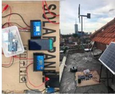
Gambar 2. 3 Sistem Monitoring dan Pengukuran Pembangkit Listrik Surya dan Angin Berbasis Internet Of Things (IoT) [4]
