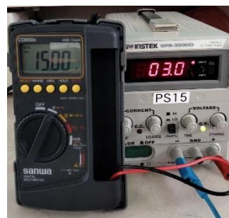
Gambar 4. 12 Pengujian buck boost dengan tegangan input 3 Volt
