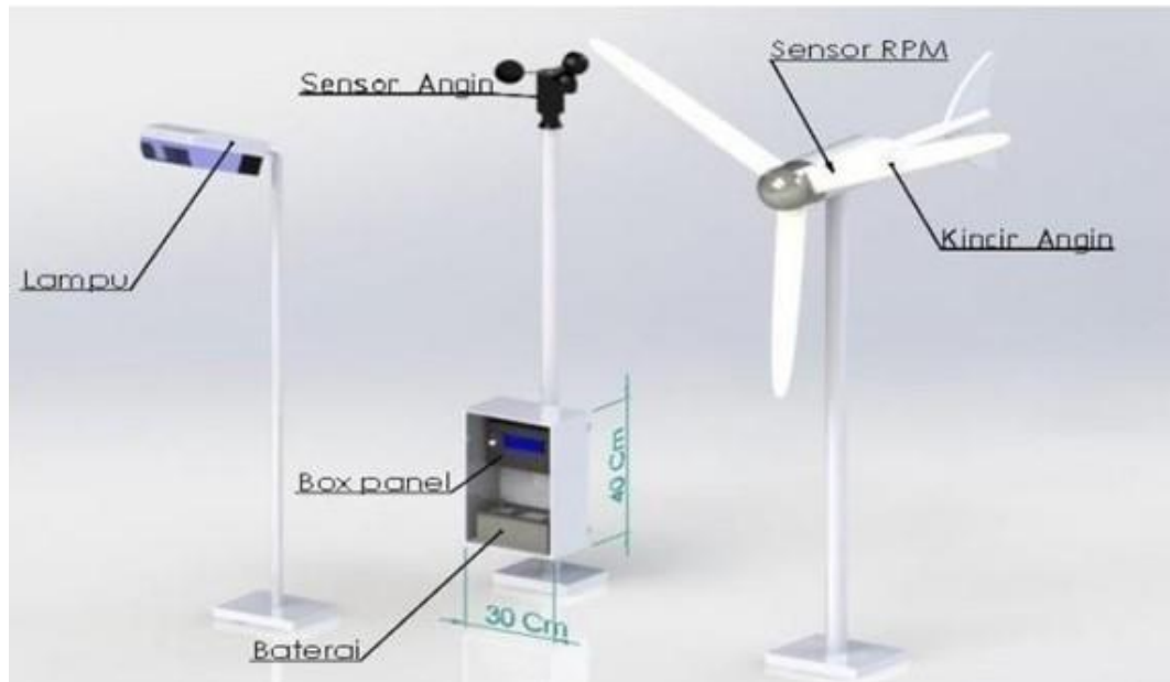
Gambar 4. 1 Desain pembangkit listrik tenaga angin untuk penerangan bagan berbasis IoT secara keseluruhan
