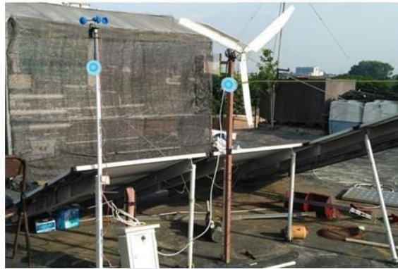
Gambar 2. 1 Rancang Bangun Sistem Pembangkit Listrik DC Tenaga Angin Berbasis Arduino [2]
