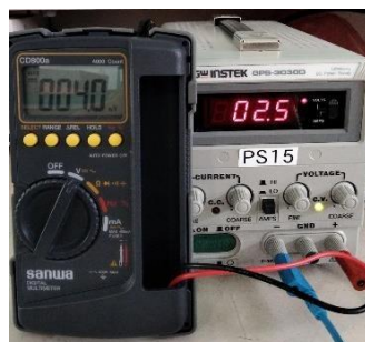
Gambar 4. 11 Pengujian buck boost dengan tegangan input 2,5 Volt
