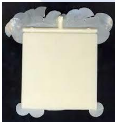
Gambar 2. 16 Cacat Produk flashing ( Defect pada produk plastik, Tresno, 2010)
