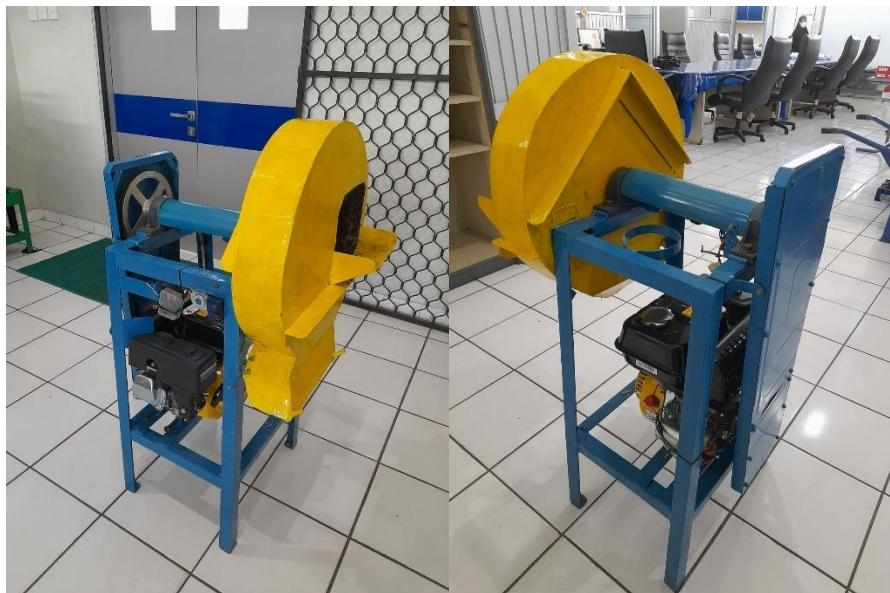
Gambar 4.8 Mesin Pencacah Pohon Pisang
