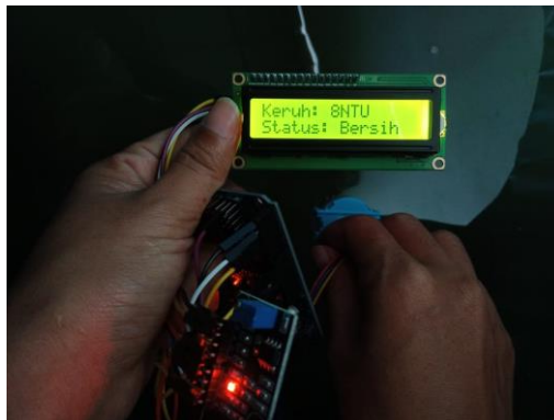
Gambar 4.27 Hasil Pengujian Sensor Turbidity Pada Air Kolam Ikan Lele
