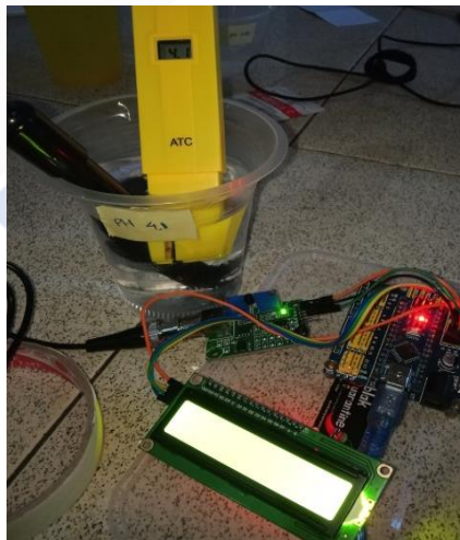
Gambar 4.33 Pengujian Sensor Ph Dengan Air 250 ML + Bubuk Ph 4.01
