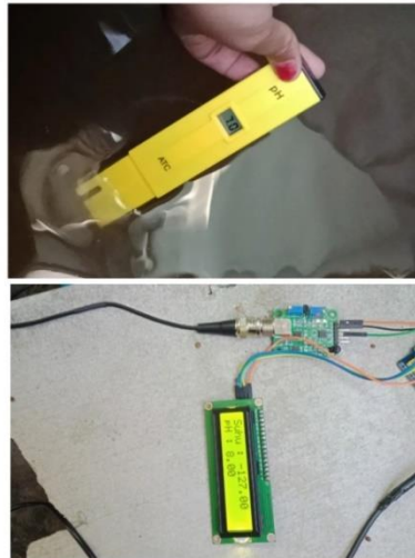
Gambar 4.39 Hasil Pengujian Sensor Ph Dengan Air Kolam
