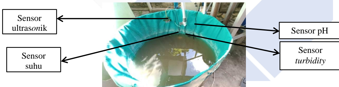
Gambar 4.7 Penempatan Sensor pada Hardware Kolam Ikan Lele
