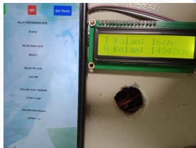
Gambar 4.56 Pengujian Volume Kolam pada Aplikasi dan LCD
