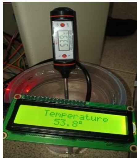
Gambar 4.44 Hasil Pengujian Sensor DS18B20 Dengan Air Biasa 50 ml + Air Panas 200 ml
