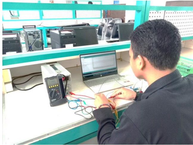
Gambar 4. 37 Proses Pengujian Sensor Tegangan
