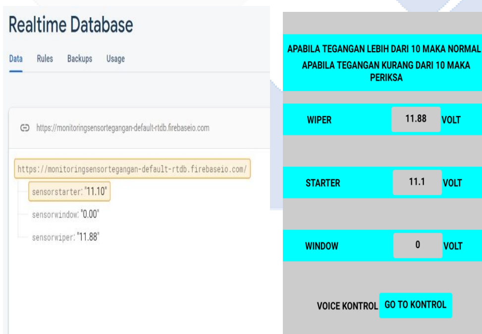
Gambar 4. 56 Hasil Pengujian Monitoring Data Sensor Tegangan Ketika Window Rusak: (a) Data sensor tegangan pada firebase ; (b) Tampilan Screen Monitoring
