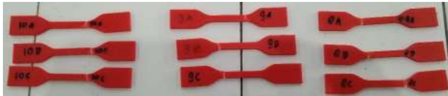
Lampiran 3. Hasil Patahan Spesimen Uji Tarik Tertinggi
