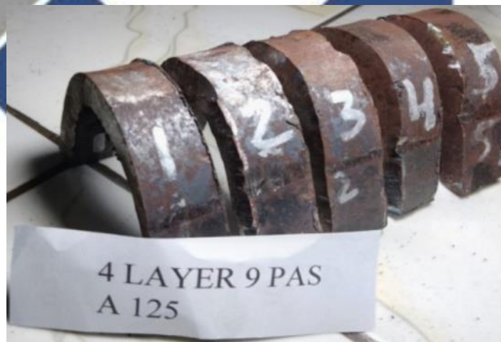
Gambar 4.3.4.5. Hasil Uji Bending 4 Layer 9 Pass 125A
