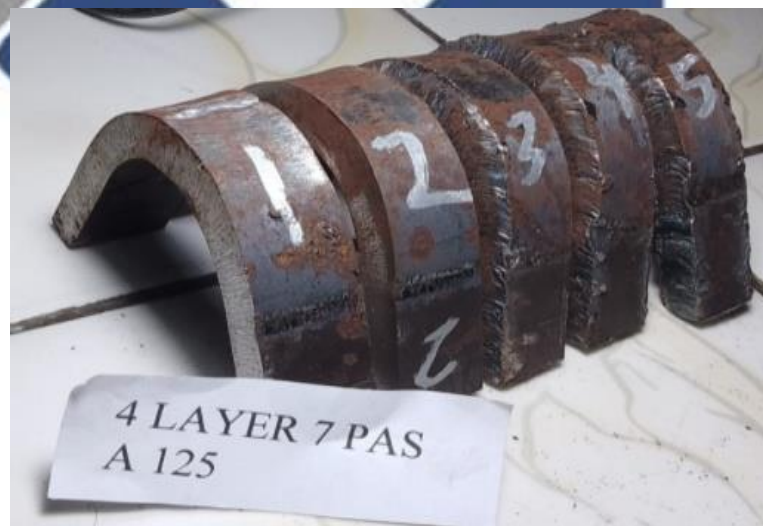
Gambar 4.3.4.4. Hasil Uji Bending 4 Layer 7 Pass 125A
