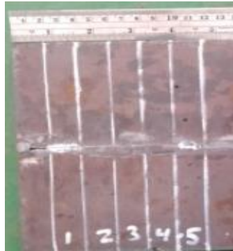
Gambar 4.3.1. Proses Penandaan Benda Uji
