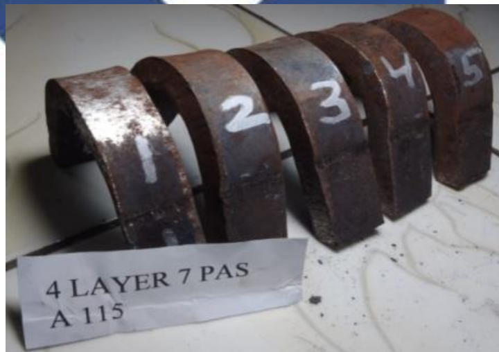
Gambar 4.3.4.2. Hasil Uji Bending 4 Layer 7 Pass 115A
