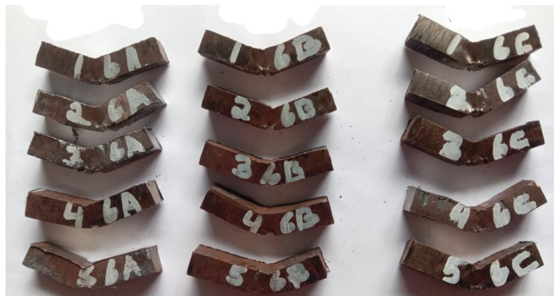
Gambar 4. 8 Hasil pengujian impact pada pengelasan 6 pass
