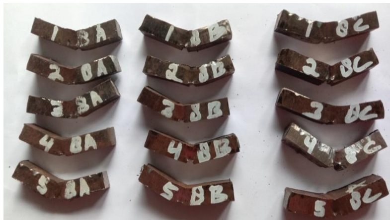
Gambar 4. 10 Hasil pengujian impak pada pengelasan 8 pass
