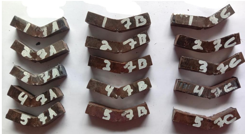
Gambar 4. 9 Hasil pengujian impak pada pengelasan 7 pass
