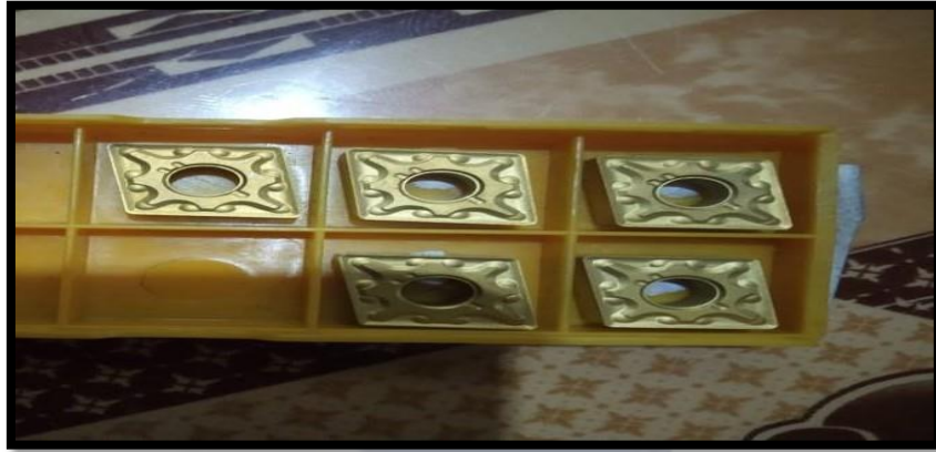
Gambar 9. Mata potong insert carbide
