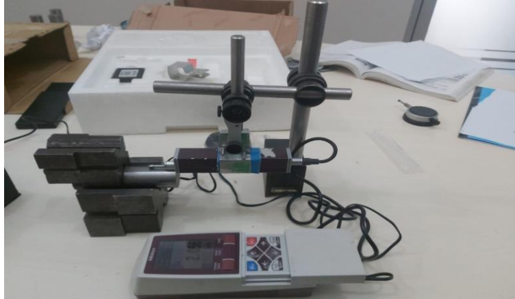
Gambar 25. Skema proses pengukuran kekasaran permukaan benda kerja
