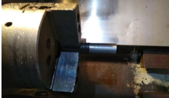
Gambar 17. Pemasangan benda kerja
