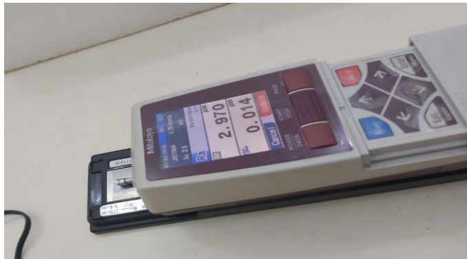
Gambar 23. Kalibrasi alat ukur kekasaran
