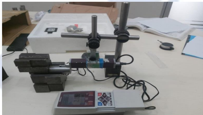
Gambar 24. Setting ketinggian benda kerja dengan alat ukur kekasaran
