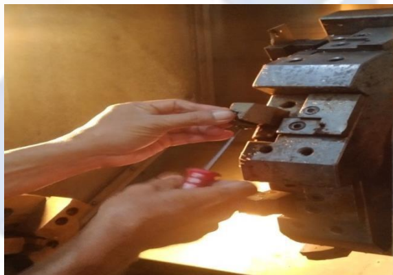
Gambar 18. Pemasangan insert carbide CNMG120408-MA
