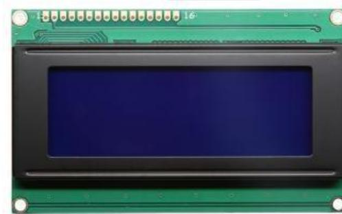
**Gambar 2. 20** LCD 20x4
