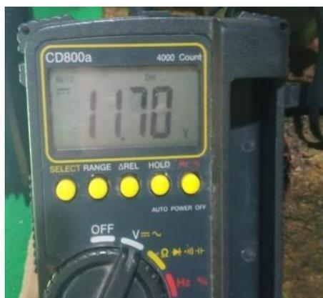
**Gambar 4. 12** Pengukuran Tegangan dengan Multitester
