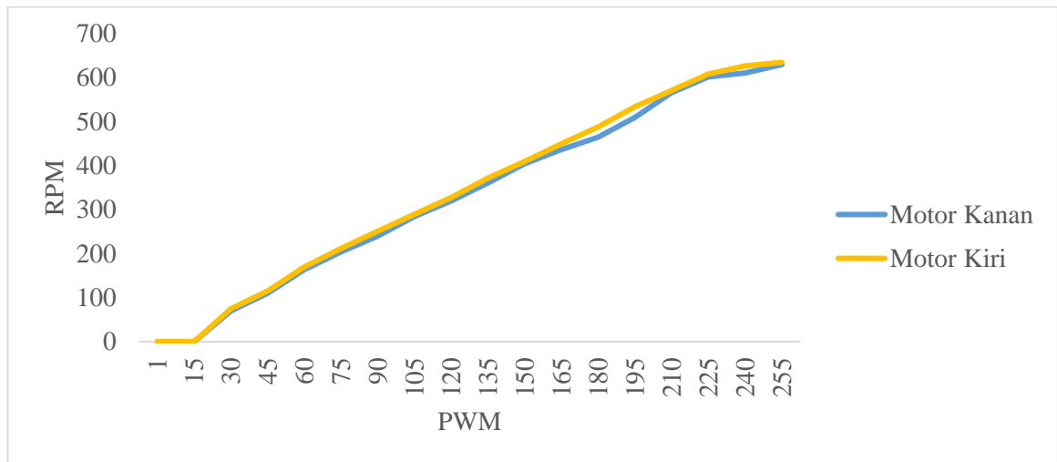
Gambar 4.16 Grafik Pengujian PWM dan RPM
