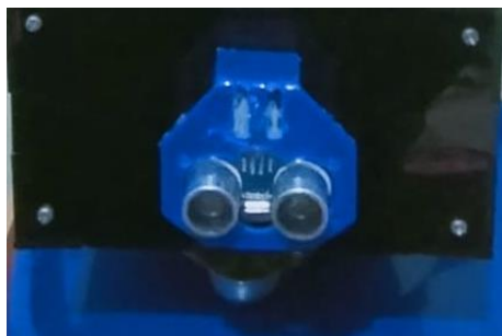
Gambar 4.14 Pemasangan sensor ultrasonik
