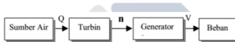
Gambar 2. 2 Diagram Blok Pembangkit Listrik Tenaga Mikrohidro (Prabowo et al., 2018)
