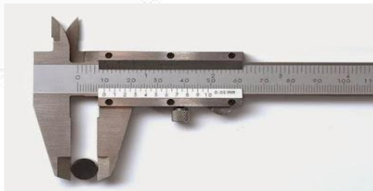
Gambar 3. 6 Jangka sorong, ketelitian 0,05 mm
