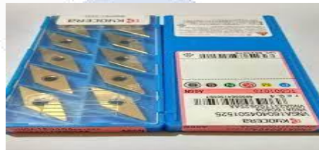
Gambar 2. 2 Mata pemotong sisipan keramik
