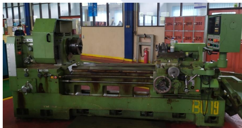
Gambar 5. Mesin Bubut Tornos Geminis S.L. SE 5 650 S
