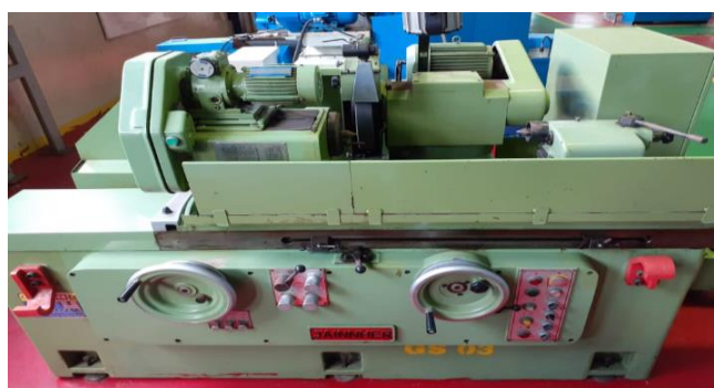
Gambar 3.4 Mesin Gerinda Silindris JAINNHER Jenis JHU-3506H
