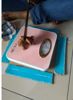
Gambar 3.2 Pengujian Nilai Beban Perajangan Lengkuas
