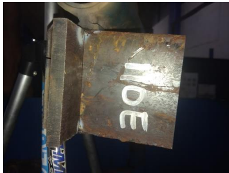
Gambar benda uji 5 (110.E) sebelum dilas
