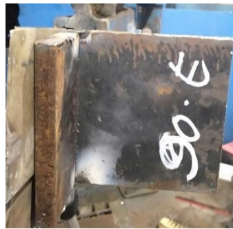
Gambar benda uji 5 (90.E) sebelum dilas
