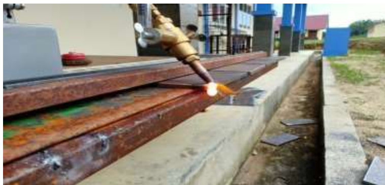
Gambar 3.3 Proses pembuatan kampuh V
