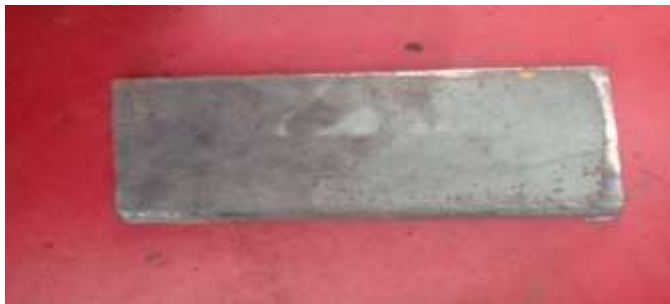
Gambar 3.2 Baja karbon St 37 ukuran 200×100×10
