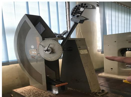
Gambar 4.1 Pengujian *Impact*
