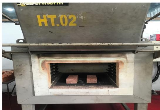
Gambar 4. Proses Pemanggangan Bata Merah
