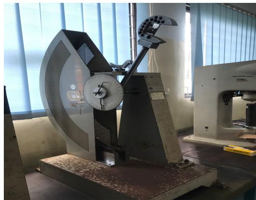
Gambar 3.6 Mesin Uji *Impact Charphy*
