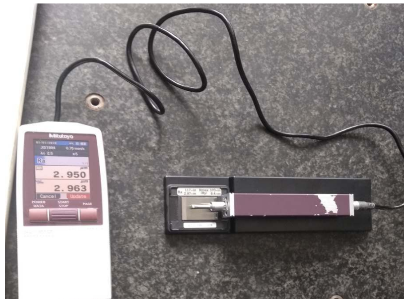
Gambar 3.15 Kalibrasi Alat Ukur Kekasaran
