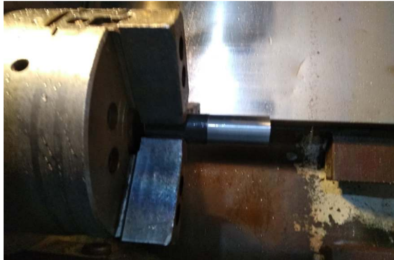
Gambar 3.10 Pemasangan Benda Kerja
