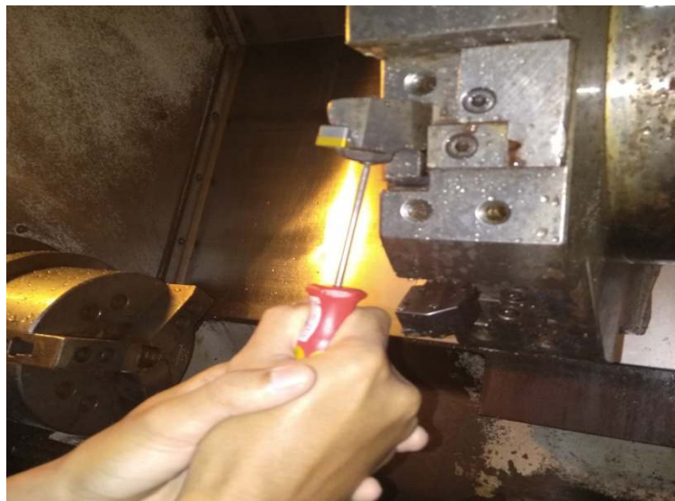
Gambar 3.11 Pemasangan Insert Carbide CNMG120408-MA
