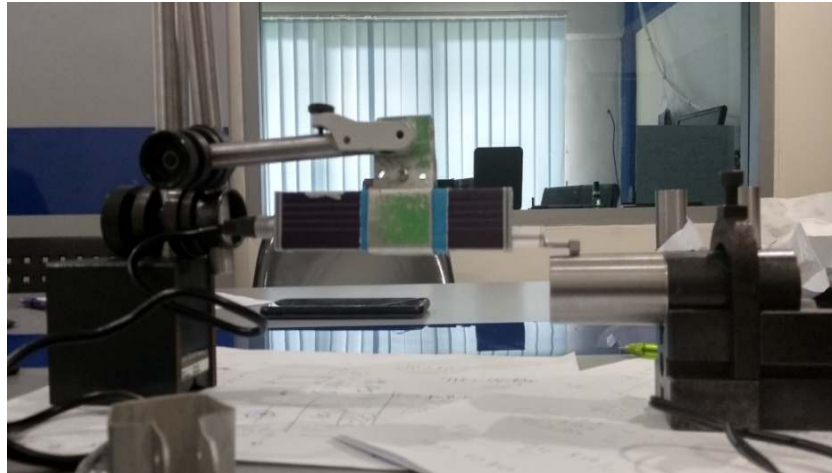
Gambar 3.16 Setting Ketinggian Benda Kerja dan Alat Ukur Kekasaran
