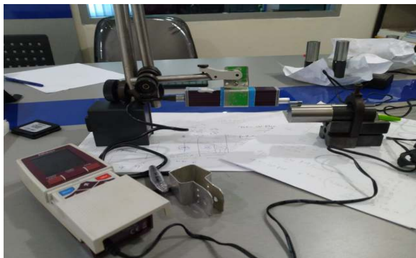
Gambar 3.17 Skema Proses Pengukuran Kekasaran Permukaan Benda Kerja
