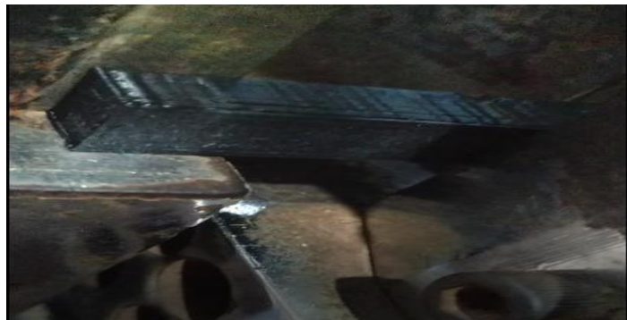
Gambar 4.6 Pengujian Impak Metode Charpy
