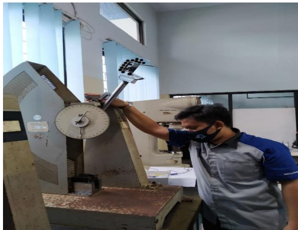
Gambar 3.9 Pengujian Impak Metode Charpy
