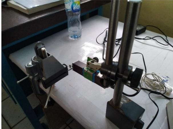
**Gambar 3.10** Proses Pengujian Kekasaran Permukaan Pada Benda Uji.
