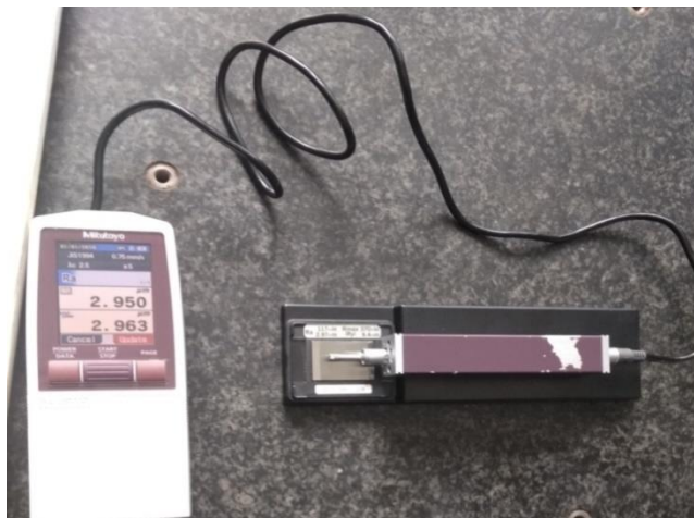
Gambar 4.1.1 Kalibrasi Alat Ukur Kekasaran
