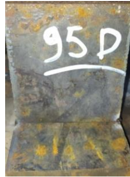
Gambar benda uji 4 (95.D) sebelum dilas
