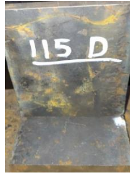
Gambar benda uji 4 (115.D) sebelum dilas
