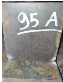
Gambar benda uji 1 (95.A) sebelum dilas
