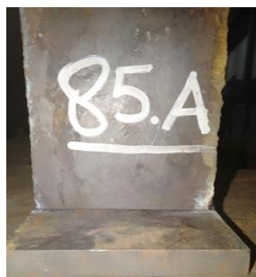
Gambar benda uji 1 (85.A) sebelum dilas
