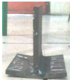
Gambar 2.7 Cacat Las Distorsi.
