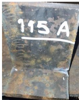
Gambar benda uji 1 (115.A) sebelum dilas
