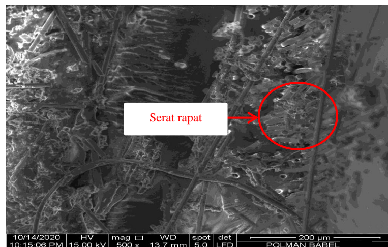
Gambar 4.15 Hasil Uji SEM Spesimen Uji Impak Tertinggi (Perbesaran 500 kali)
