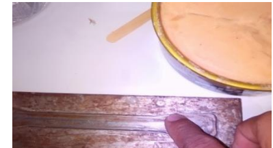
5. Pemberian wax glass pada cetakan
