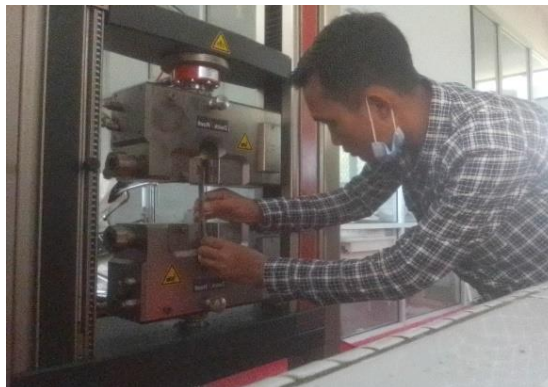
Gambar 4.1 Proses Uji Tarik
