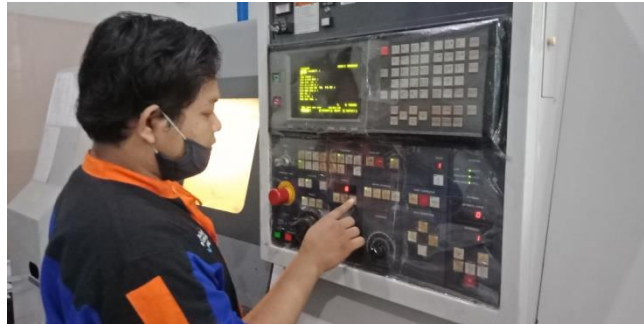
Proses menjalankan program CNC bubut
