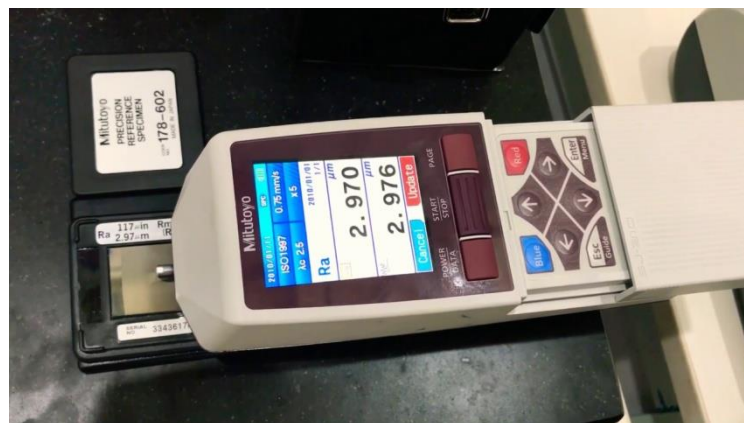
Gambar 3.7 Alat Uji Kekasaran Surface Roughnes Tester
