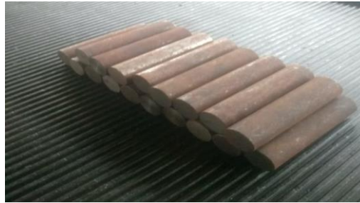
Gambar 3.8 Benda Uji Baja St41
