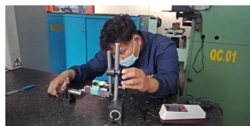
Proses pengambilan data menggunakan alat uji kekasaran
