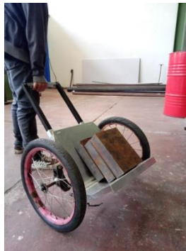
Gambar 4.8 Uji beban pada troli
