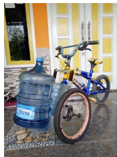
Gambar 4.9 Uji beban pada troli sebagai dudukan sepeda
