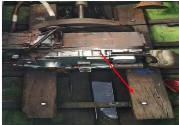
**Gambar 2. 2** Pondasi Mesin Perahu
