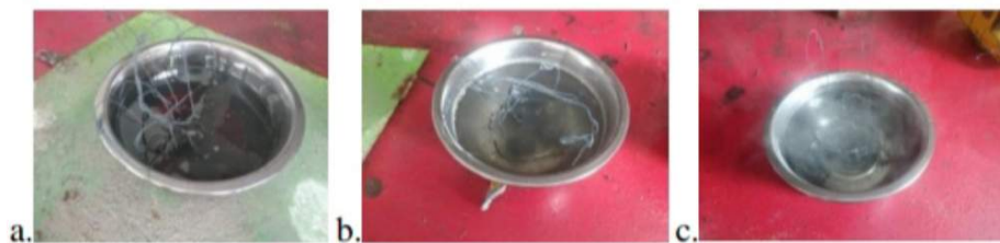
Gambar 4.5 Spesimen Yang Telah di hardening a.oli, b.air garam. c.air
