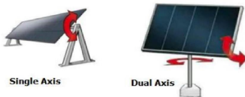
Gambar 2. 1 Jenis Solar Tracker berdasarkan sumbu putar [1]
