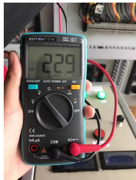
Gambar 4.19 Tampilan Hasil Pengukuran pada Fasa S-Netral
