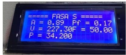
Gambar 4.6 Tampilan LCD pada Fasa S
