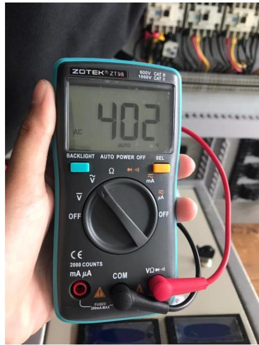
Gambar 4.22 Tampilan Hasil Pengukuran pada Fasa S-T
