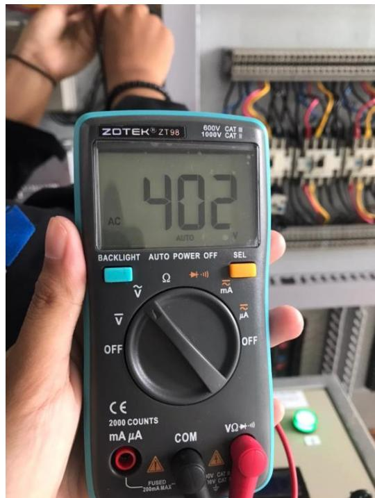
Gambar 4.33 Tampilan Hasil Pengukuran pada Fasa R-S
