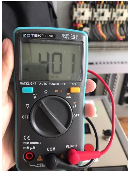
Gambar 4.40 Tampilan Hasil Ukur pada Motor U1-W1
