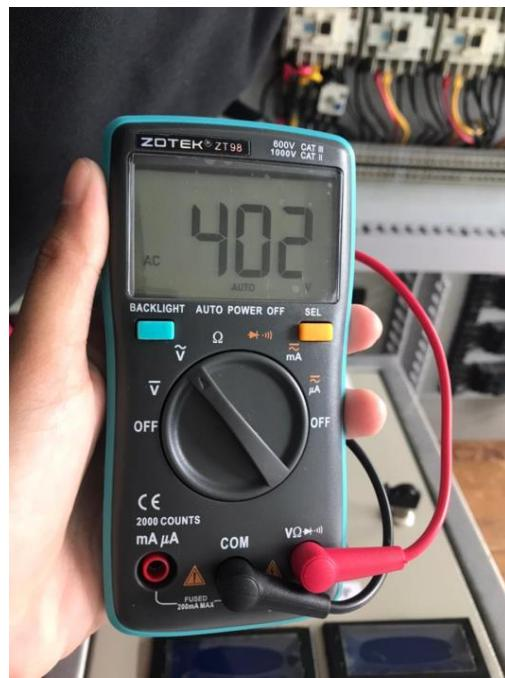
Gambar 4.21 Tampilan Hasil Pengukuran pada Fasa R-S
