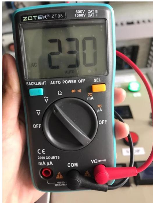
Gambar 4.31 Tampilan Hasil Pengukuran pada Fasa R-Netral
