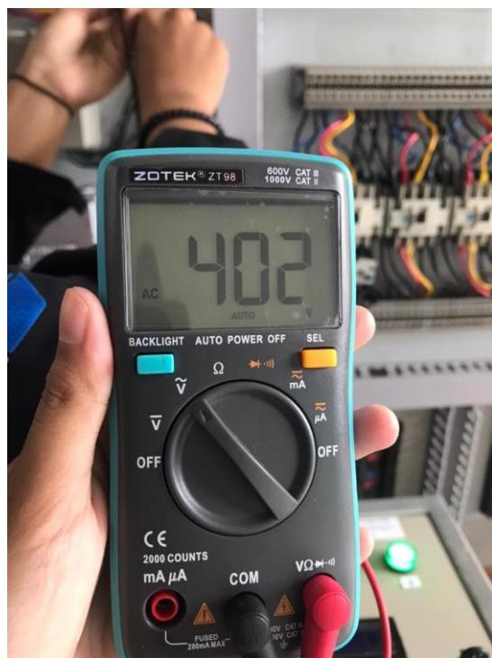
Gambar 4.35 Tampilan Hasil Pengukuran pada Fasa R-T
