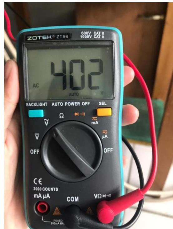
Gambar 4.27 Tampilan Hasil Pengukuran pada Motor U1-V1
