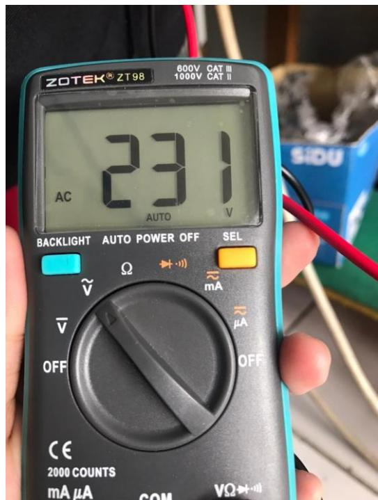
Gambar 4.37 tampilan Hasil Pengukuran pada Motor V1-V2
