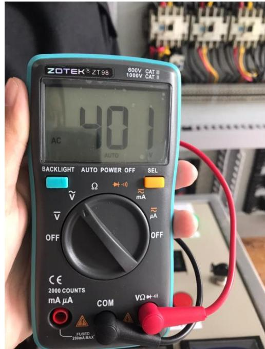
Gambar 4.41 Tampilan Hasil Ukur pada Motor V1-W1
