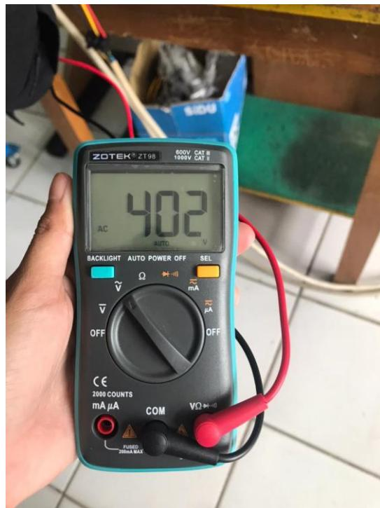
Gambar 4.28 Tampilan Hasil Pengukuran pada Motor V1-W1
