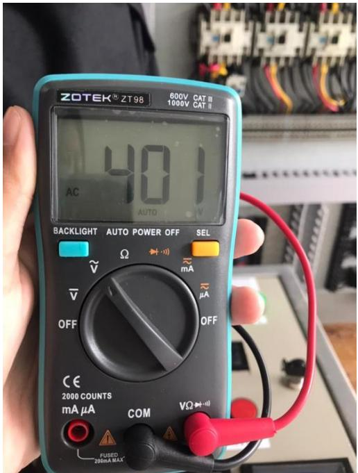
Gambar 4.23 Tampilan Hasil Pengukuran pada Fasa R-T
