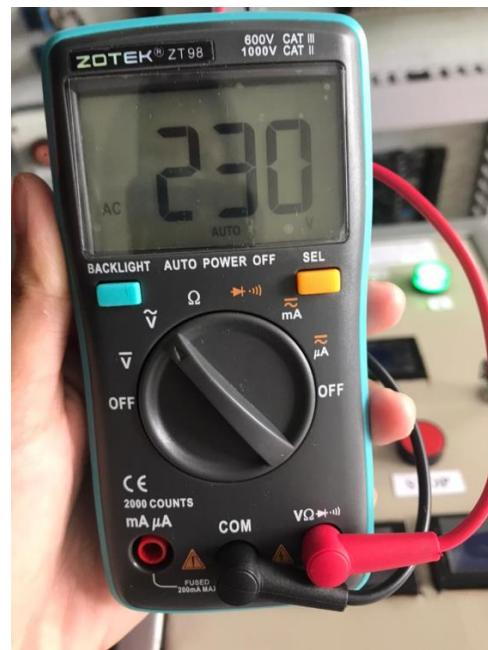
Gambar 4.18 Tampilan Hasil Pengukuran pada Fasa R-Netral
