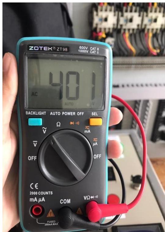
Gambar 4.29 Tampilan Hasil Pengukuran pada Motor U1-W1
