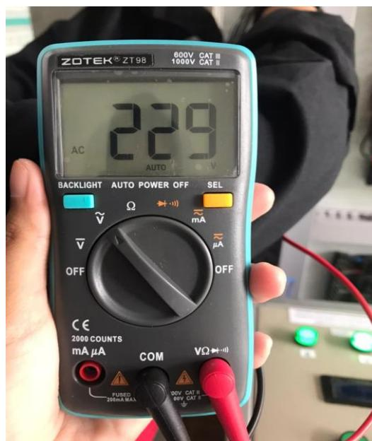
Gambar 4.30 Tampilan Hasil Pengukuran pada Fasa S-Netral
