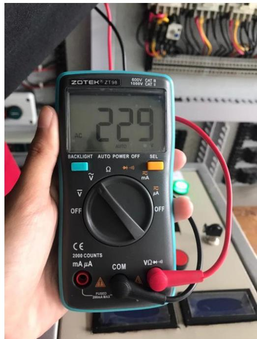
Gambar 4.32 tampilan Hasil Pengukuran pada Fasa T-Netral
