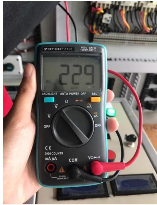
Gambar 4.20 Tampilan Hasil Pengukuran pada Fasa T-Netral
