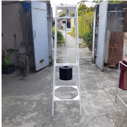
Gambar 4.2 Kerangka alat dan kipas turbin yang sudah jadi
