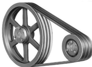
**Gambar 2.7** *Pulley dan V-Belt*
