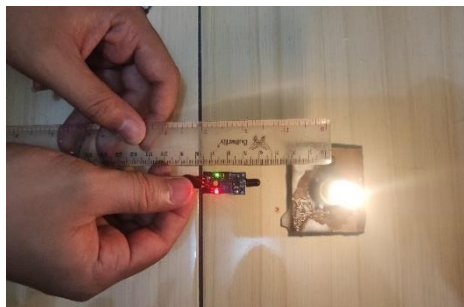
Gambar 4. 16 Pengujian Flame Sensor pada Jarak 4 cm dan Sudut 0^\circ
