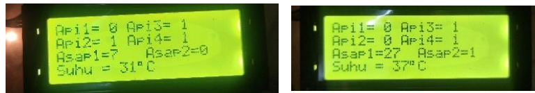
Gambar 4. 53 Tampilan LCD Ketika Terdeteksi Api pada Ruang 2
