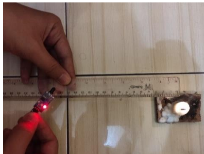
Gambar 4. 20 Pengujian Flame Sensor pada Jarak 16 cm dan Sudut 70°
