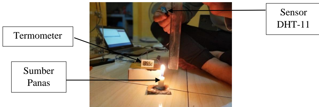
Gambar 4. 34 Pengujian Sensor DHT-11 pada Jarak 15 cm terhadap Lilin
