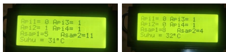
Gambar 4. 52 Tampilan LCD Ketika Terdeteksi Api pada Ruang 1
