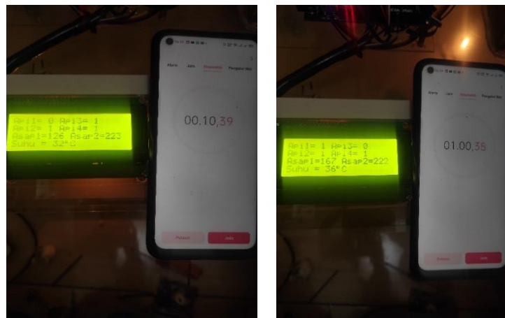
Gambar 4. 64 Tampilan LCD Terdeteksi Api dan Asap pada Ruang 1
