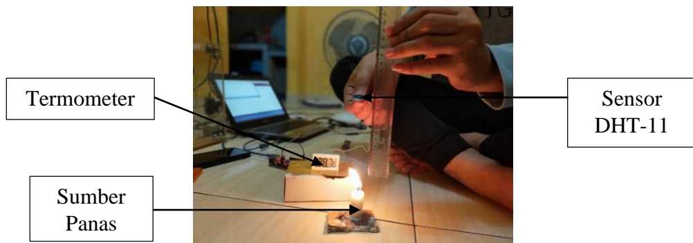
Gambar 4. 32 Pengujian Sensor DHT-11 pada Jarak 10 cm terhadap Lilin
