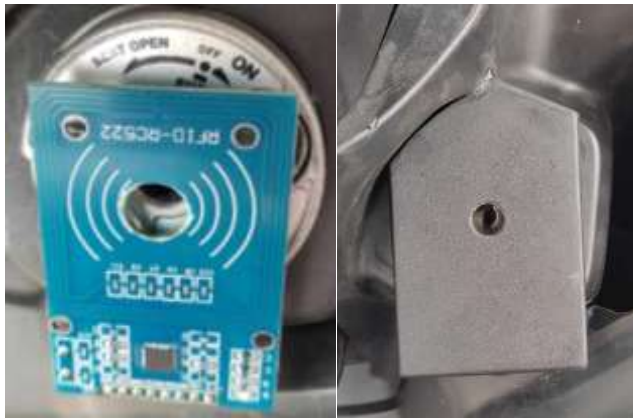
Gambar 4.2. Pemasangan RFID Reader
