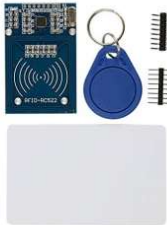
Gambar 2.1 RFID Tag dan Reader [3].
