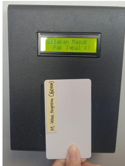
Gambar 4.11 Tampilan uji coba menggunakan RFID card
