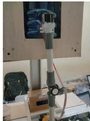
Gambar 4. 27 Pemasangan Water Flow Sensor
