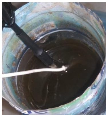
Gambar 4. 15 Gambar Pengujian Limbah Cair Kelapa Sawit dengan Sensor Suhu dan Thermometer
