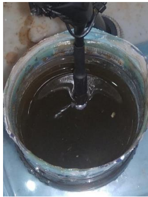
Gambar 4. 13 Gambar Pengujian Limbah Cair Kelapa Sawit dengan Sensor Suhu DS18B20
