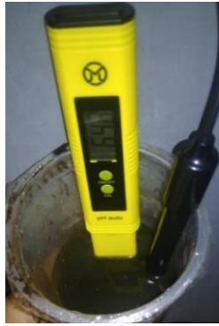
Gambar 4. 24 Gambar Pengujian PH Limbah Cair Kelapa Sawit dengan Sensor PH dan PH Meter
