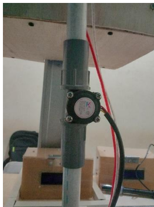
Gambar 4. 27 Pemasangan Water Flow Sensor
