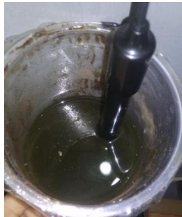
Gambar 4. 22 Gambar Pengujian Limbah Cair Kelapa Sawit dengan Sensor PH
