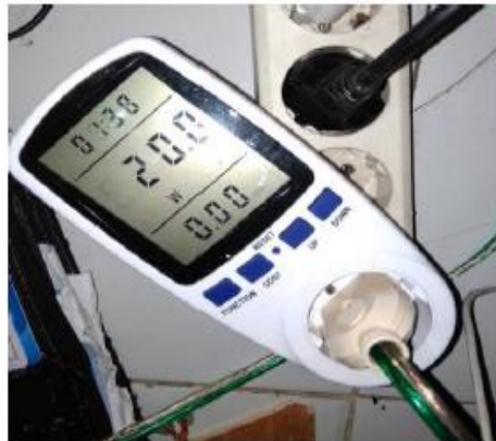
Gambar 4.35 Pembacaan daya dengan wattmeter
