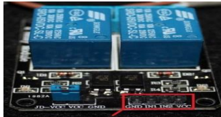
Gambar 2.2 Hubungan modul relay dengan arduino mega 2560
