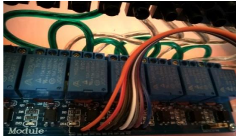
Gambar 4.14 Modul relay yang sudah dirangkai
