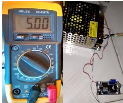
Gambar 4.20 Pengukuran tegangan output buck converter
