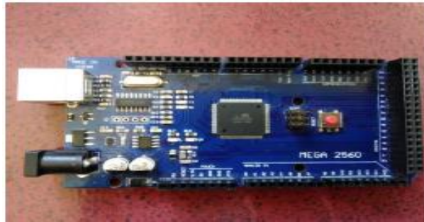
Gambar 4.7 Bentuk fisik arduino mega 2560
