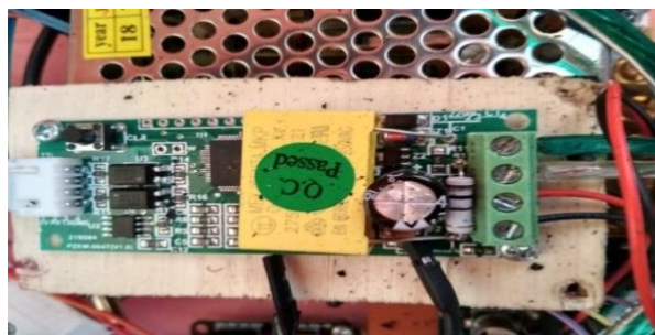
Gambar 4.33 Modul PZEM-004T yang sudah dirangkai
