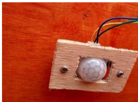
Gambar 4.29 Sensor PIR yang sudah dirangkai
