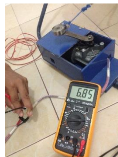
Gambar 4.12 Pengujian tegangan dengan mode LOW
