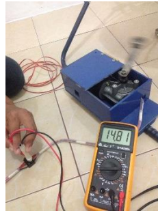
Gambar 4.13 Pengujian tegangan dengan mode HIGH
